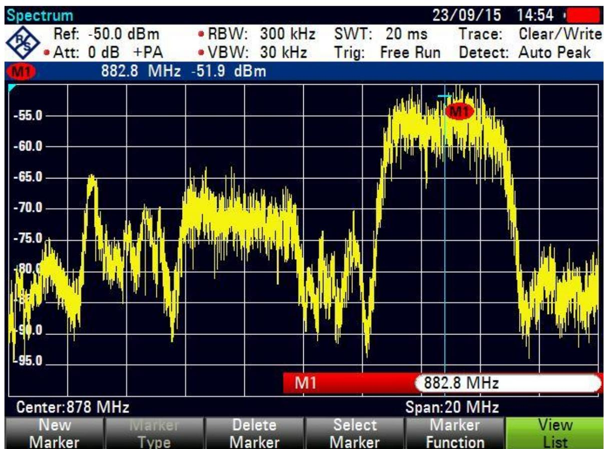
Espectro na faixa de 850 MHz da operadora SMP no interior da cela na unidade prisional com o sistema BSR desligado
