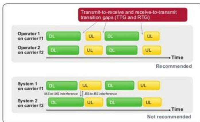
Figura 23 - Sincronização de Redes para evitar bloqueio de redes TDD.
