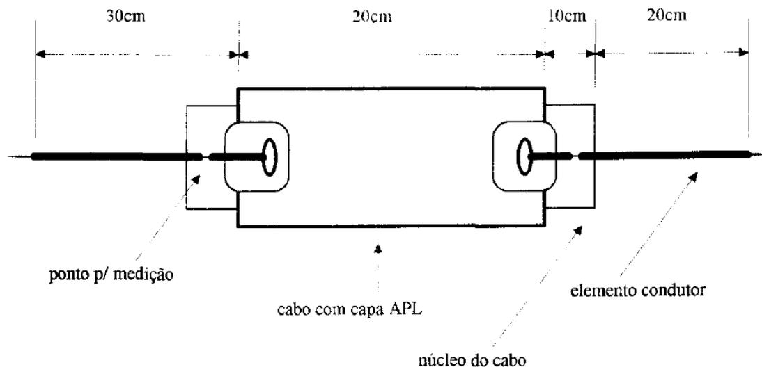
5. Para os ensaios dos grupos II, III, IV e V, devem ser preparados 3 corpos de prova utilizando cabo CTP APL 40-20 e 3 corpos de prova utilizando cabo CTP APL 40-200. Podem ser utilizados outros cabos com capa APL, desde que os diâmetros sejam os mesmos.
