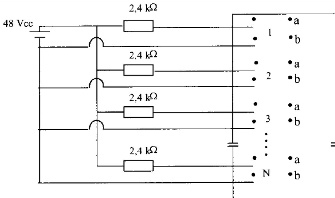
IV. Ligar a fonte e ajustar a tensão em 48 Vcc. Ajustar a corrente de curto-circuito da fonte, considerando curto-circuito em todos os pares, ou seja, 20 mA multiplicado pelo número de pares energizados.
