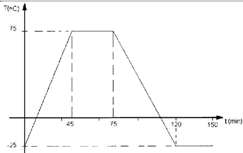
III. Completados os 300 ciclos, retirar os corpos de prova da câmara climática, deixá-los estabilizar nas condições normais de laboratório e verificar a sua integridade física e estrutural.
