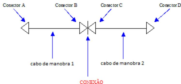
Figura 1 - Montagem do corpo-de-prova
