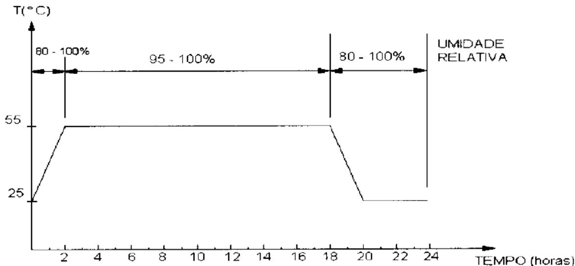
VI. Após o 20º ciclo, retirar a tensão dos corpos de prova destinados à medição de resistência de isolamento com umidade, desconectar os resistores, retirar da câmara climática e realizar a medição de resistência de isolamento com umidade, conforme o item c).
