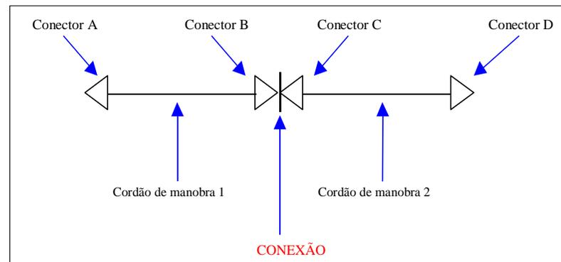
Figura 1 - Montagem do corpo-de-prova
