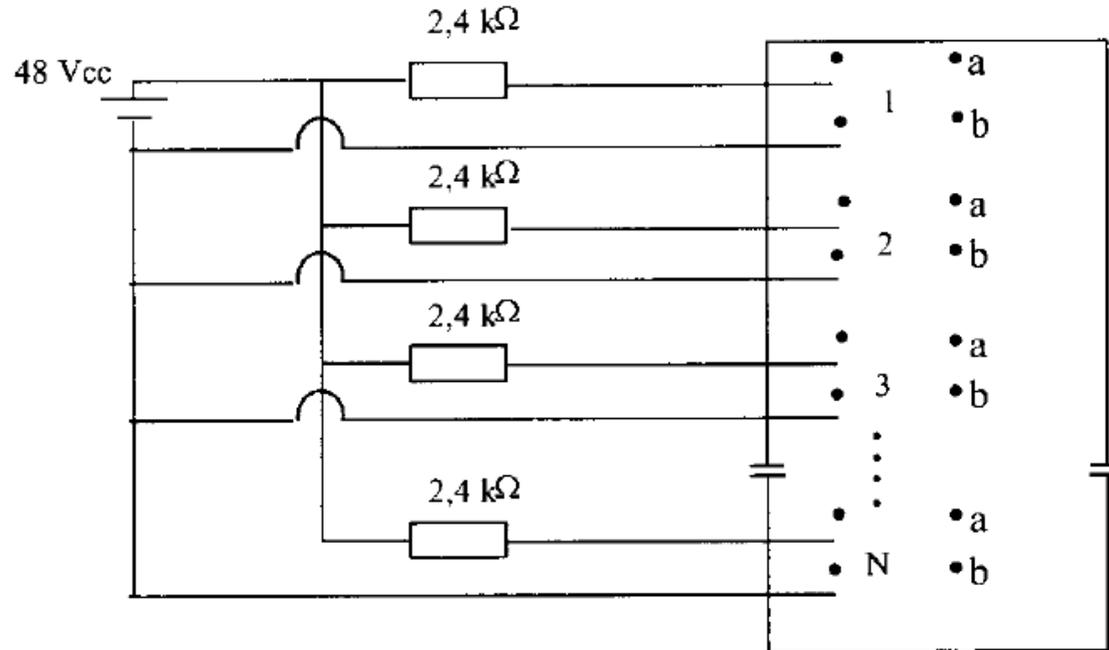
IV. Ligar a fonte e ajustar a tensão em 48 Vcc. Ajustar a corrente de curto-circuito da fonte, considerando curto-circuito em todos os pares, ou seja, 20 mA multiplicado pelo número de pares energizados.
