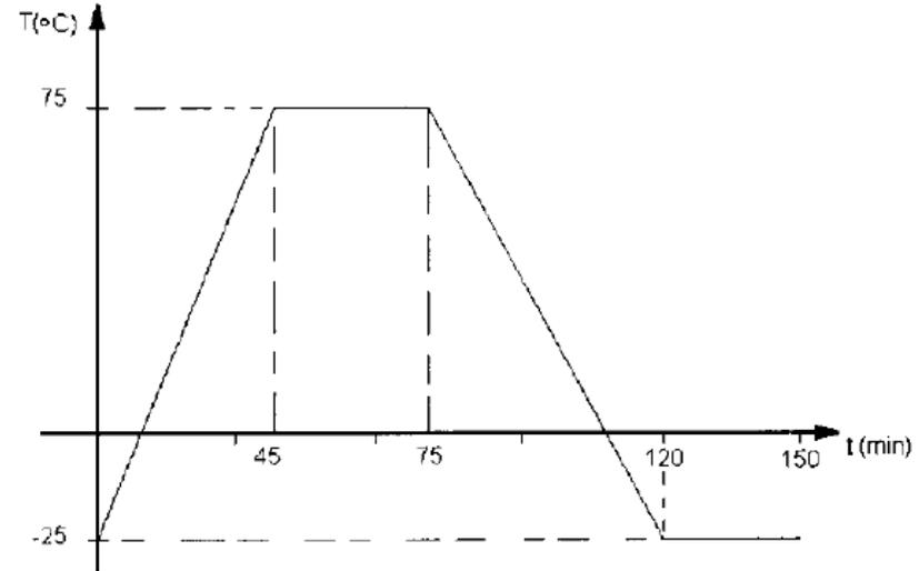
III. Completados os 300 ciclos, retirar os corpos de prova da câmara climática, deixá-los estabilizar nas condições normais de laboratório e verificar a sua integridade física e estrutural.
