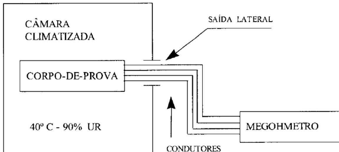
II. Proceder o condicionamento à temperatura de (40 ± 2) °C e umidade relativa de (90 ± 3)%, com período de estabilização de, no mínimo, 2 horas.
